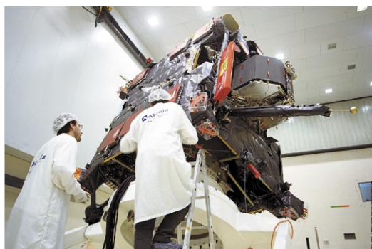
l'Atterrisseur Philae fixé sur l'une des faces de Rosetta avant son lancement. © ESA.
